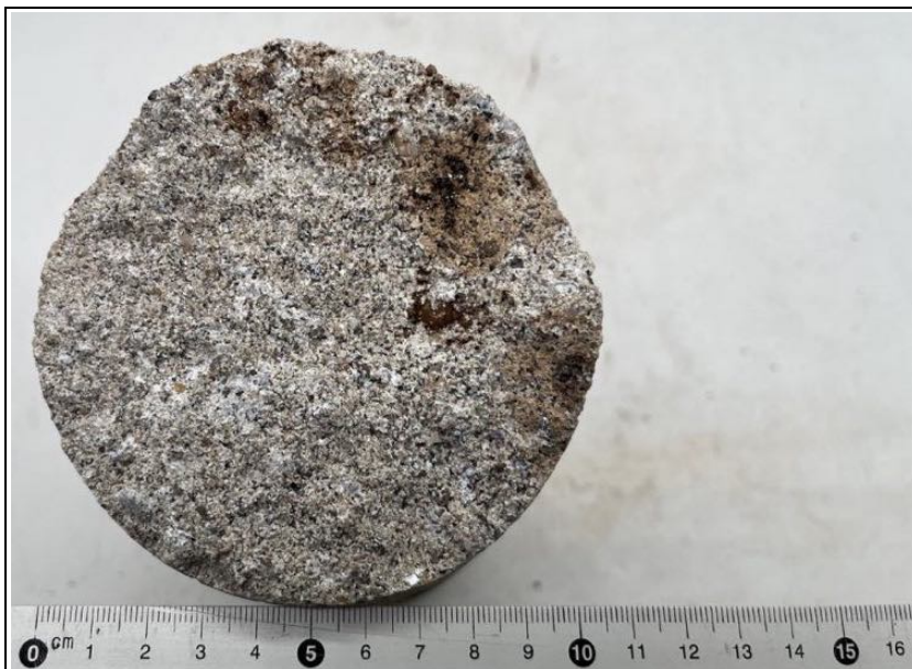
Protokoll ProAn Bild 37: Bruchfläche am Bohrkernende nach Anlieferung, der Bruch verläuft mehrheitlich durch den Feinmörtel mit braunen Verfärbungen
