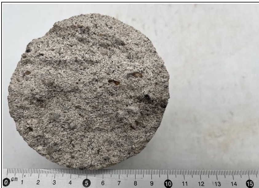
Protokoll ProAn Bild 28: Bruchfläche am Bohrkernende nach Anlieferung, der Bruch verläuft mehrheitlich durch den Feinmörtel
