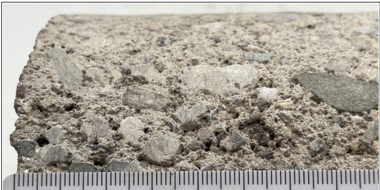
Protokoll ProAn Bild 20: Mantelfläche Detailaufnahme. Hohe Porosität an der Mantelfläche nahe an der Oberseite.
